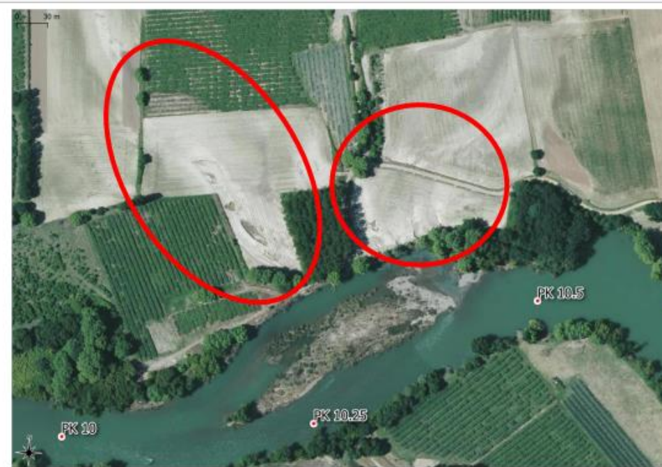
Figure 16 : Toumbe - Ortho 2018 - érosions en rive droite
